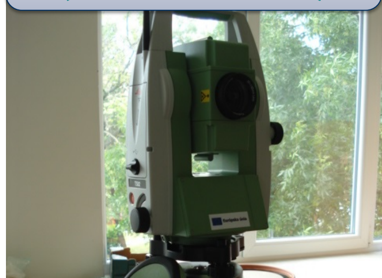
Totálna stanica (Leica FlexLine TS02)
