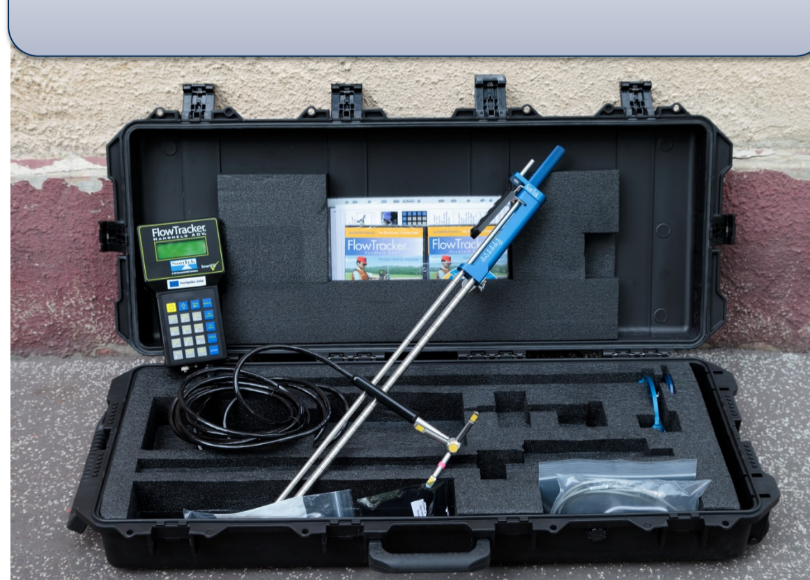
Prístroj na meranie rýchlosti prúdenia vody v prirodzených (SonTek FlowTracker - 3D)
