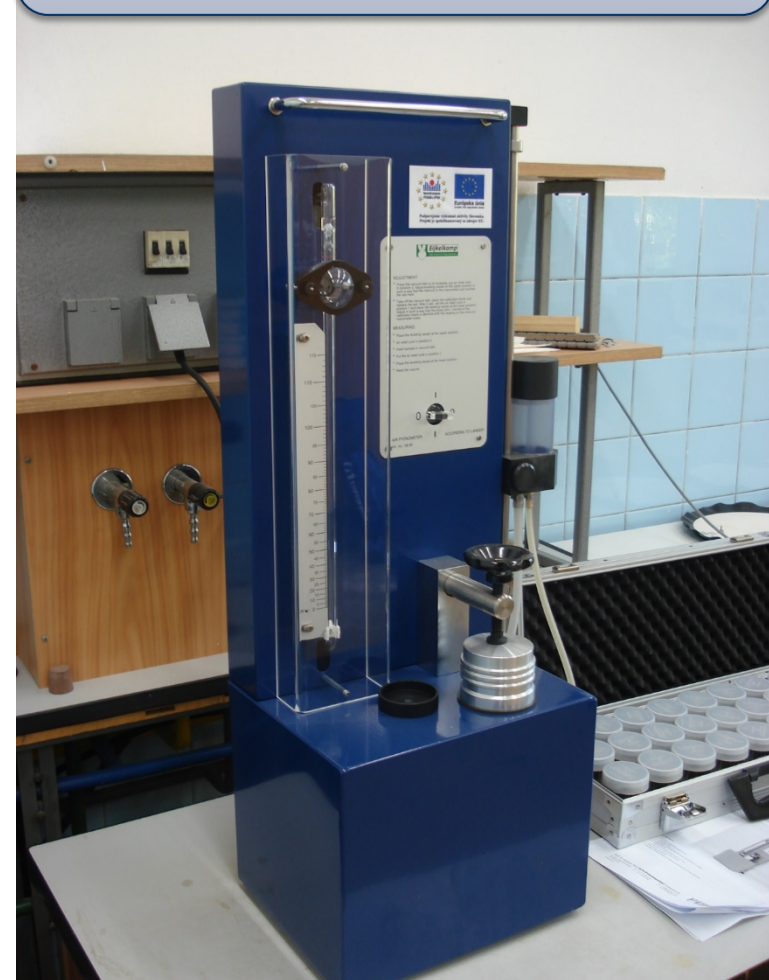
Vákuový pyknometer (Eijkelkamp)
