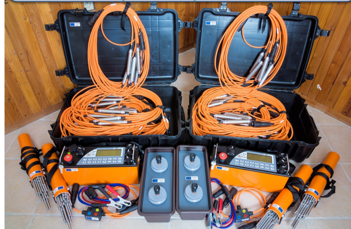
Systém na terénne meranie elektrickej vodivosti a indukovanej polarizácie pôdneho profilu
