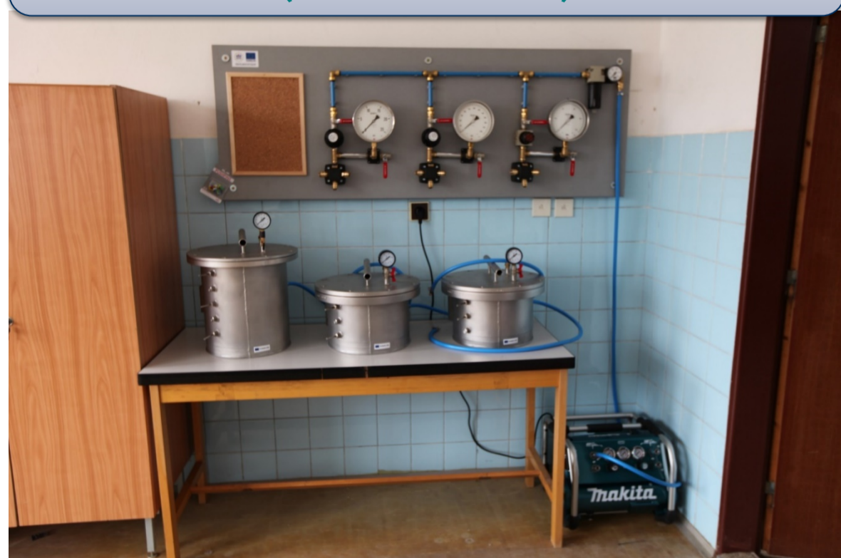
Vákuový pyknometer (Eijkelkamp)
